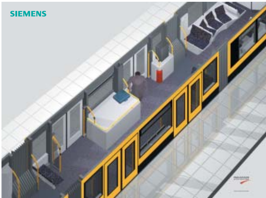
In den Fahrgastraum integriert: das dieselelektrische Stromerzeugungsaggregat und der Tank mit Fahrkartenautomat
