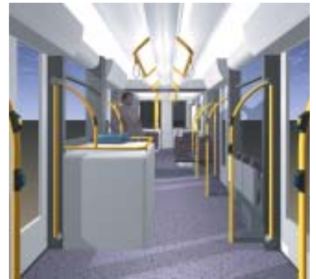
Blick in den Fahrgastraum auf das dieselelektrische Stromerzeugungsaggregat
