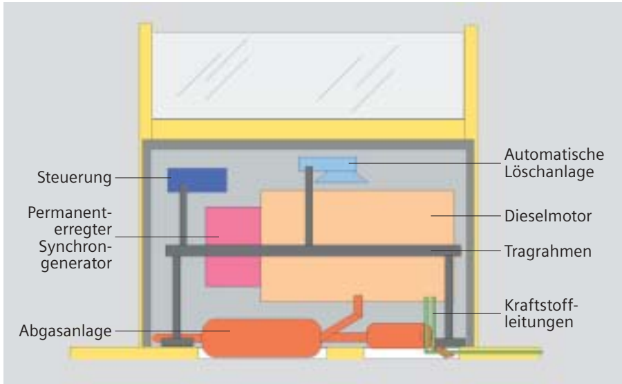
Grafische Darstellung des dieselelektrischen Stromerzeugungsaggregates (DSA)
