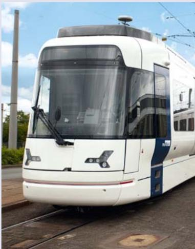
Bahnsteigkante breiter. Mit 2,65 Meter Breite bietet der Vamos rund 230 Fahrgästen Platz. Großzügige Mehrzweckabteile bieten Raum für Rollstuhlfahrer, Eltern mit Kinderwagen, Fahrgäste mit Rollatoren und Fahrräder.
